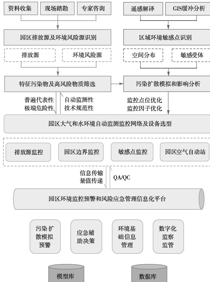
图1 预警系统建设的总体技术路线图
