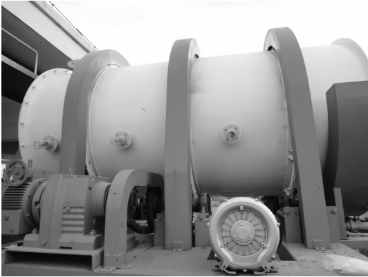
图 4 动态好氧发酵装置现场图
