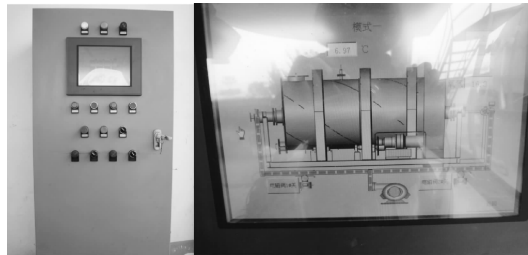
图 5 动态好氧发酵装置电气控制
