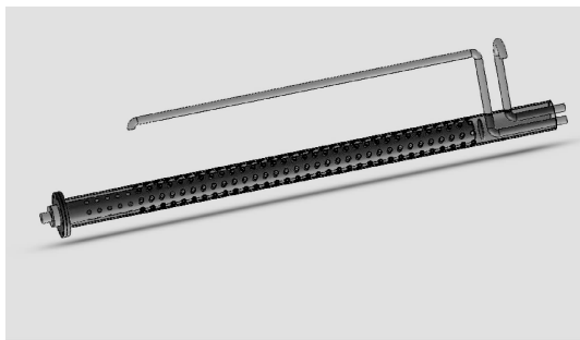
图 2 好氧动态堆肥设备中心曝气通风轴示意图
